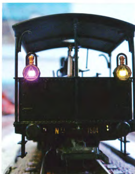
Ved rangering er der violet lys til venstre, hvidt til højre, såvel for som bag.
