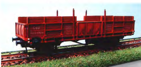
En speciel vogntype, litra VtDr fra CSD - Åben godsvogn med sidestøtter litra Nsk - med RIV-mærkning
