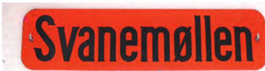
Svingskilt fra en ældre motorvogn. Sort tekst på rød bund markerede remisekørsel. Foto Spor og baner
