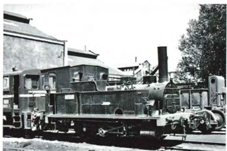
El Selmo på sine gamle dage med lukket førerhus og forhøjet kulkasse, nu litreret Renfe 030-0204. Foto Wikimedia
