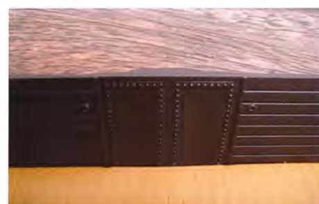
Også indvendigt er vognkassen fremstillet med alle detaljer – normalt er siderne helt glatte på modeller.
