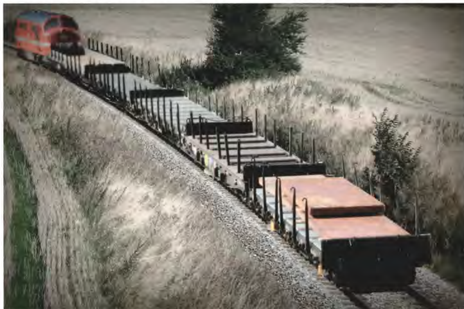
Fra broen ved Borupgaard. Der køres tomme vogne til Frederiksværk sent om aftenen. Bageste vogn har returgoods med, måske en fejlproduktion? Det er – usædvanligt – en kort Rmms 663, som sært nok kørte tom fra Frederiksværk et par dage senere. Foran denne vogn ses en Samms 710 og lige efter lokomotivet en Res 687 med lave aluminiums-sidevægge. Herimellem endnu et par Rs-vogne.
