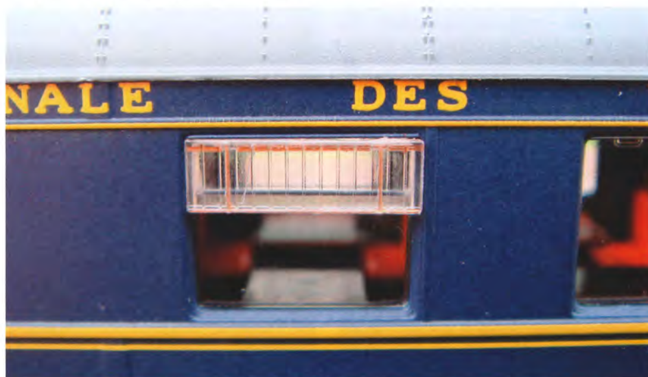
Vinduerne har de korrekte 'bricards' for modvirkning af træk - men de burde have haft messingpræg.
