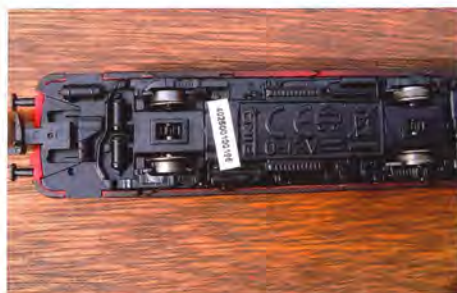
Træk på to aksler og hæfteringe på den ene.
