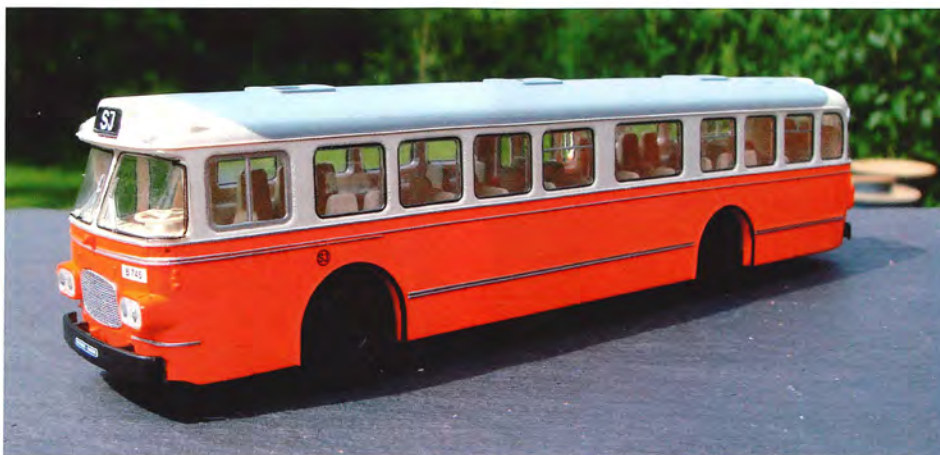
Scania CF ombygget til højrekørsel - se det brede vindue bagest, her sad dørene.
