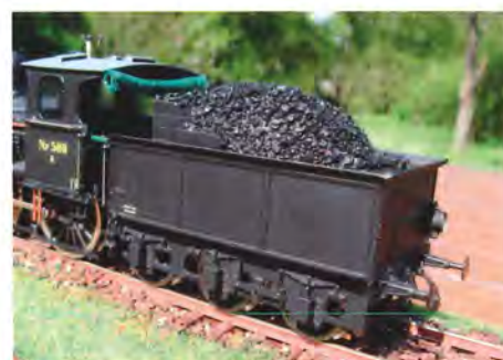
Tenderen har det fine svaj oppe ved kanten, som var et af de typiske kendetegn ved k-maskinen.
