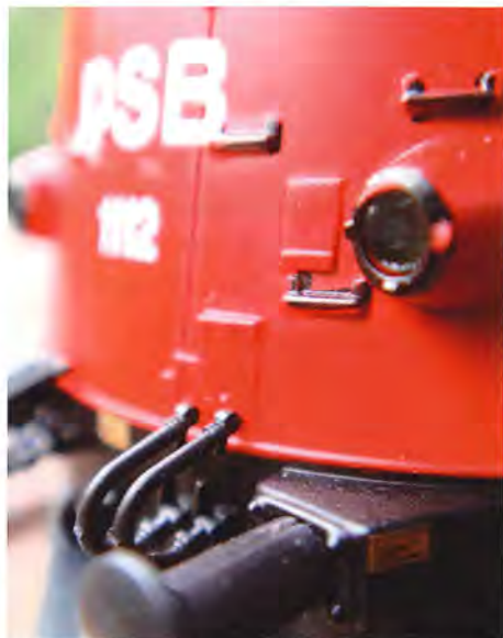
Håndbøjlerne på fronten er blot støbte og derefter bemalede.
