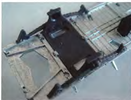
Trykstøbte undervogne af metal med nye pinollejer højner såvel kvalitet som køreegenskaber.
