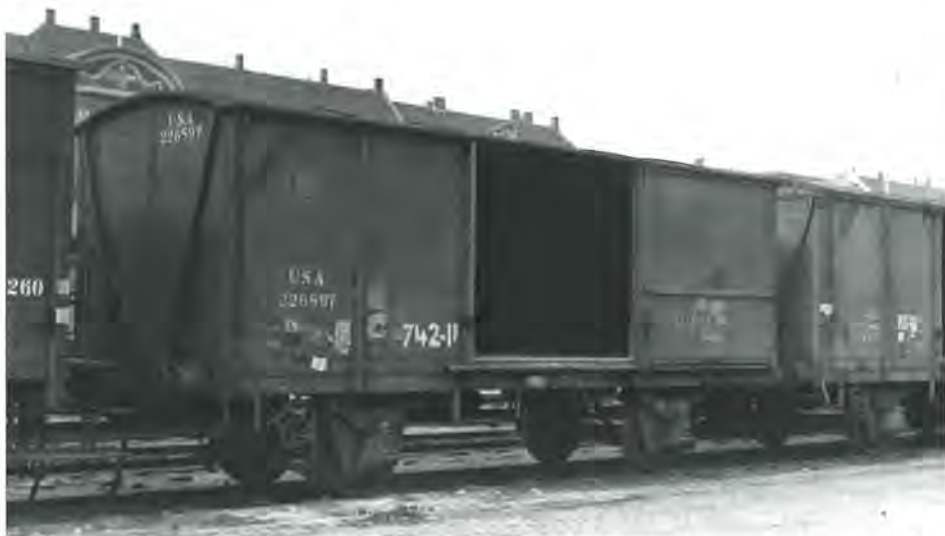
Sidevægge af krydsfiner, gavle af brædder. USA 226897 på Østerport Station sidst i 1940'erne. Foto N. Laugesen, arkiv Danmarks Jernbanemuseum.
