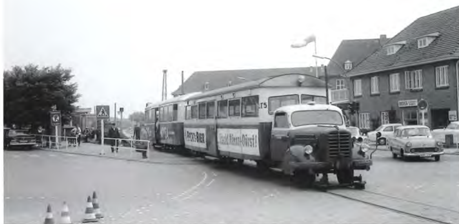
Borgwardmotorvognen LT5. Bemærk de små børster foran hjulene, som sikkert var nødvendige, når sandet fra stranden blæste ned i sporet.
