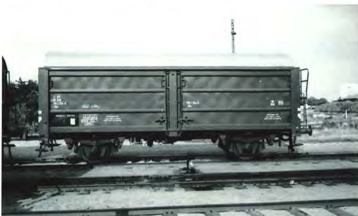
Selvom skydedørene som sådan egentlig var helt glatte med forstærkningsprofiler, afslører skyggerne, at dørene buler ud og ind. Vognen, His21 86 210 2 354-6, holder her i Grindsted den 6. august 1967. Billedet er taget af K.E. Jørgensen.
