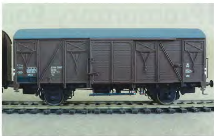
Den kommende model af en serie 3-vogn, som er uden bremseplatform
