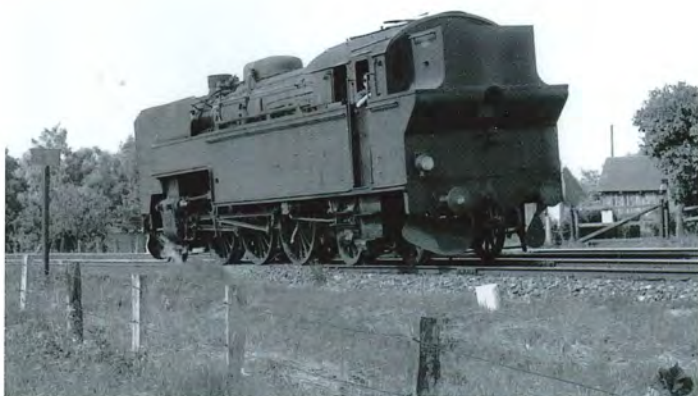
Nu må de mangle lokomotiver i København. S 728 kom solo på vej sydpå. Bemærk den store kulkasse, som alle S-maskinerne fik sidst i 1930-erne, da man ønskede, at lokomotiverne fik større kulbeholdning, så de kunne køre fra København til Gedser.
