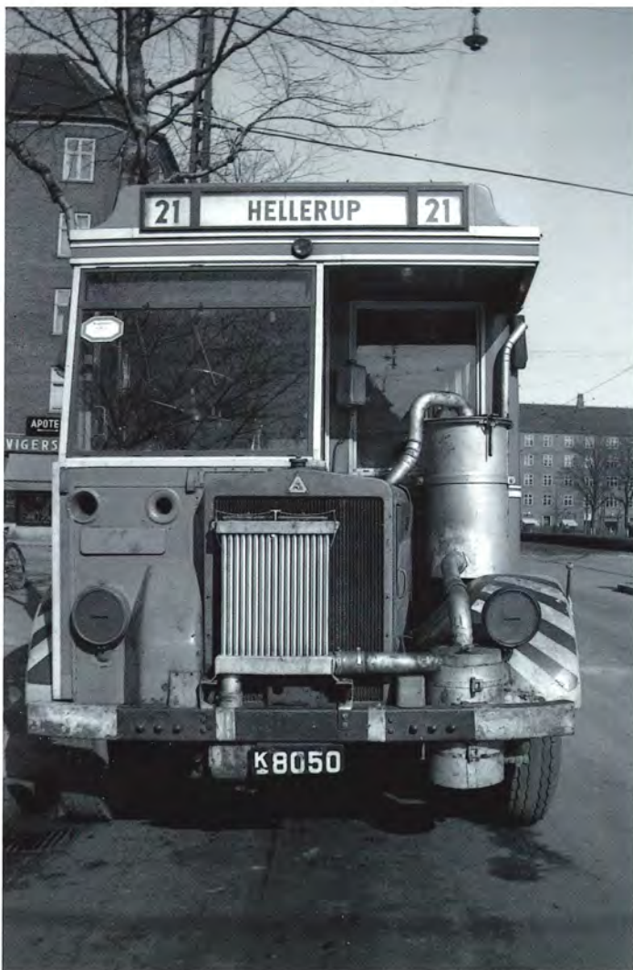
KS-bybus på Toftengårds Plads med fuld 'krigsudrustning' - ekstra køler til gengassen. Foto Jan Walter 1941.
