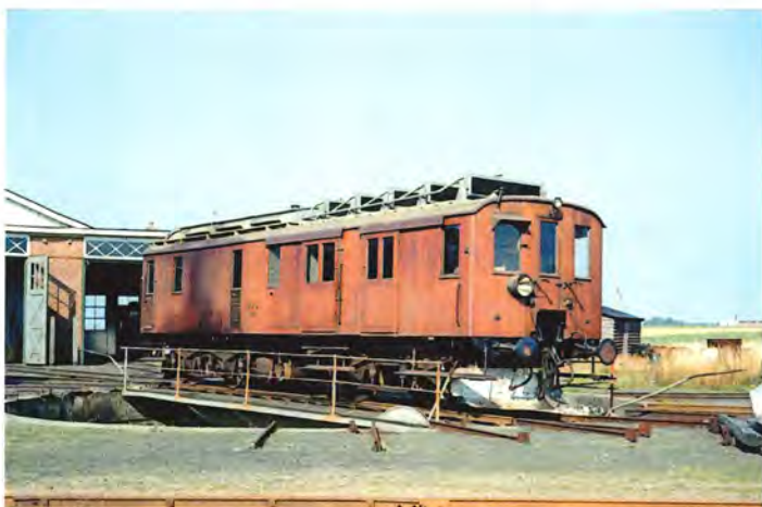
DMJK-tur, Spøttrup. SVJ M 5 Scandia 1928. Leveret med lenkaksler, men senere ombygget til bogier.
