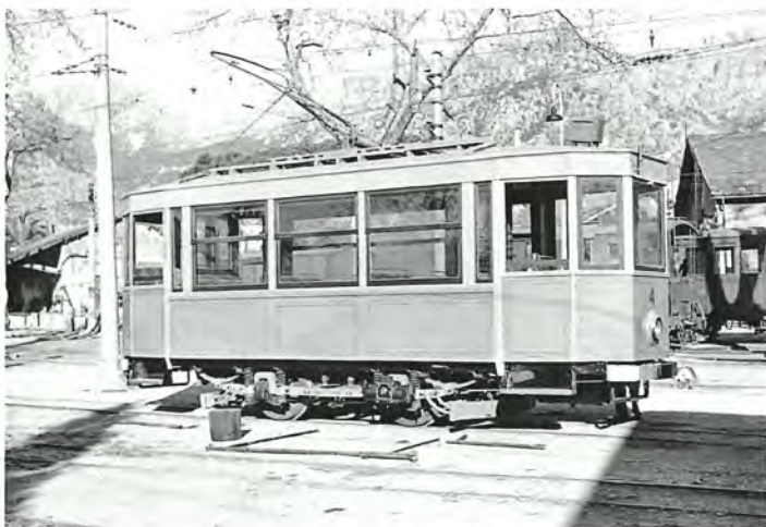
Den tidligere motorvogn U 52 fra Bilbao, her som vogn 4 fra FdS. I Bilbao kørte man med trolleytostang, men man brugte lyrebøjle i Sóller. Foto J. Wiseman.
