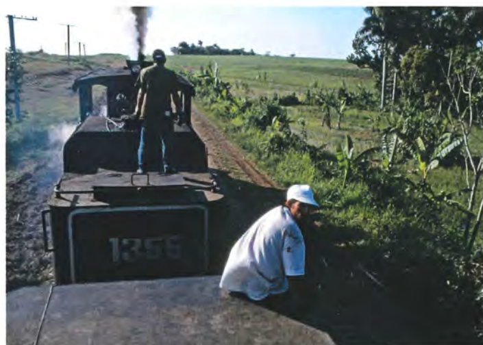
Et godt sted at fotografere tog fra er oppe på tenderen. Den forreste tender er ombygget til olieforsyning.
