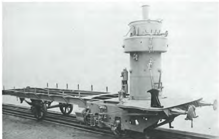
Kittel-dampvogn i råtilstand. På billedet ses bl.a. smørepumpe, styreblok, luftpumpe og selve kedlen. Arkiv Badische Eisenbahn.
