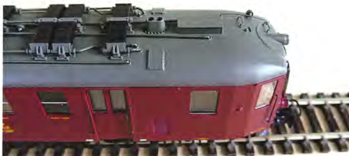
Meget fine tagdetaljer. Den forreste køler er olie-køleren. Foto Vagn Holstein.
