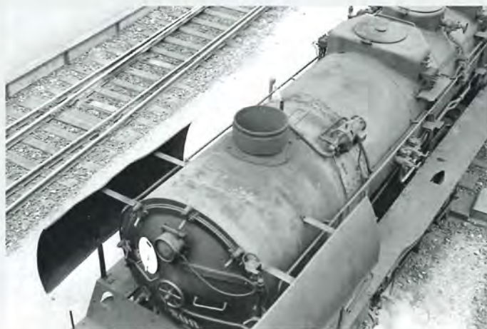
▲ N 208 som særtogsmaskine i Nyborg. Her kan man se nogle af kedeltrygsdetaljerne såsom dynamoen og én af de tre domer. Foto Kaj Pedersen.
