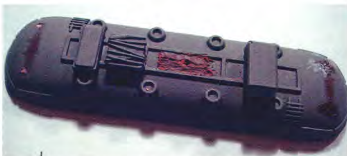
Taget er slebet ned på midten - her skal pantografen monteres.
