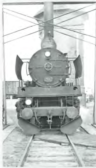
▲ N 208 som særtogsmaskine i Nyborg. Her kan man se nogle af kedeltrygsdetaljerne såsom dynamoen og én af de tre domer. Foto Kaj Pedersen.
