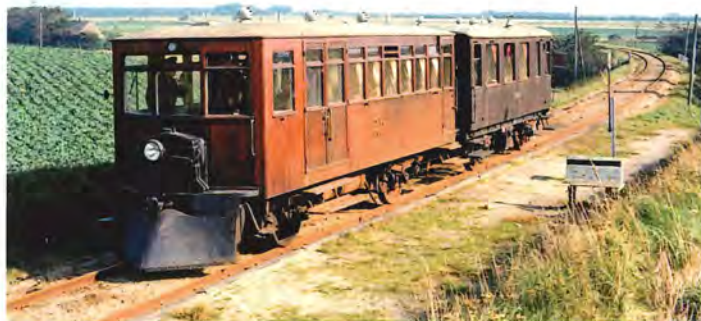
DMJK-tur. SVJ no. 1 og B 1 ved Viadukten trinbræt. Bygget af Triangel 1924. Oprindelig centralkobling, men nu kun på fronten. Købt 1966 af privatperson. I 1995 købt af Danmarks Jernbanemuseum.
