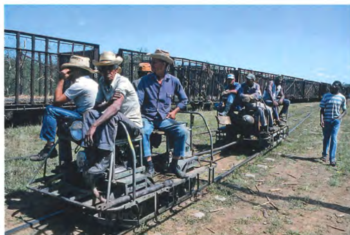
Banekolonnen krydser med toget. Motortroljen havde en boksermotor fra en russisk Ural-motorcykel – en piratkopi af en BMW-motor.
