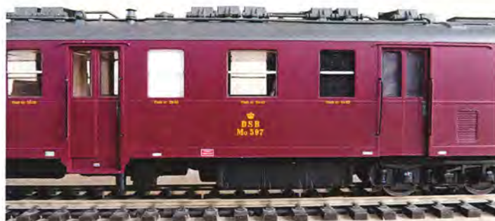
Til højre for den venstre dør ser man koksfyret og på taget den tilhørende skorsten og sikkerhedsventil. Gardinerne skulle have været blå. Bemærk den flotte litrering. Foto V. Holstein.
