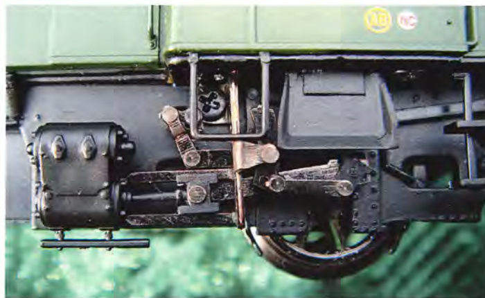
Gangtøj og cylinder på dampvognen - desværre med en ret dominerende Phillips-skrue midt i... Foto Spor og baner.
