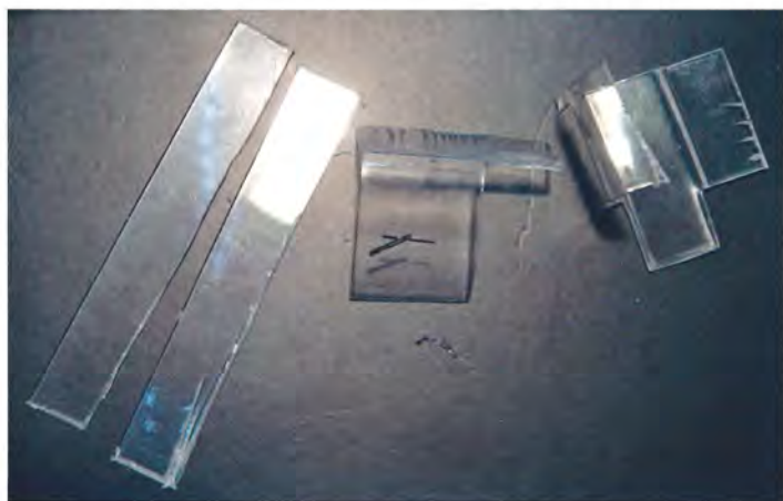
Vinduer skæres til - som det ses, splintrer de nemt.
