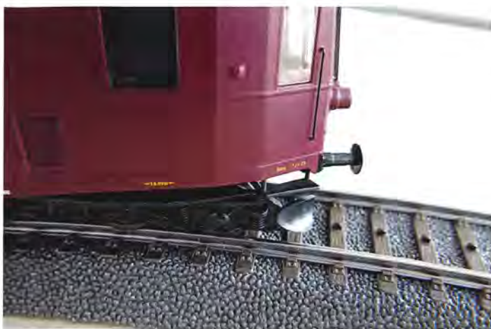
Ved at sætte rangertrinet lidt for højt op kan det gå frit af bogien. Foto Vagn Holstein.
