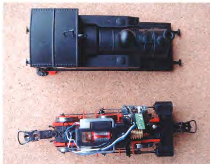
Modellen har træk på forreste aksel, men der er ikke meget plads til dekoder eller print.
