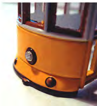
Fronten på motorvognen med de to 'knaster' og den fremspringende vulst, der skal slibes ned.
