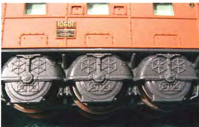
Büchli-drevet set tæt på - flot i skala 1-160.
