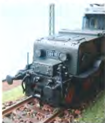
Fronten med de fleste småting monteret – påfaldende, at lokomotivet har kurvpufer.
