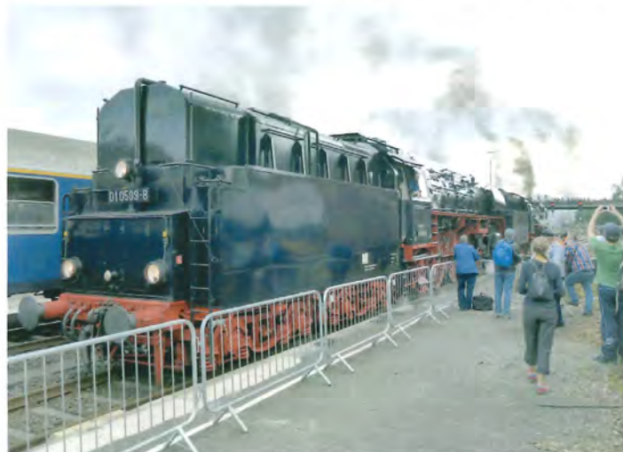
Østtysk rekonstrueret 01 509 med olietender og den lange kasse på kedelryggen.
