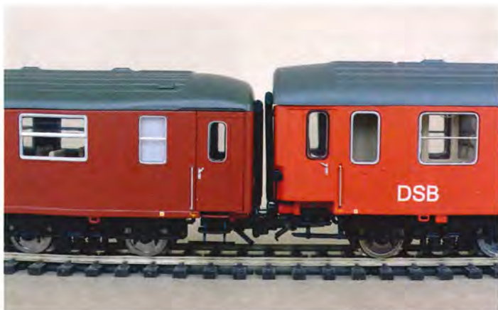
Her er BL-vognen koblet med en B-vogn – der er for stor højdeforskel mellem de to vogne. Foto Vagn Holstein.
