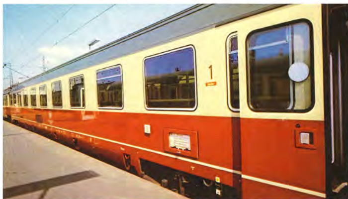
Avmz-vogn af anden generation, hvilket kan ses på dørhåndtagene og det store luftgitter midt på vognsiden. Foto DB.
