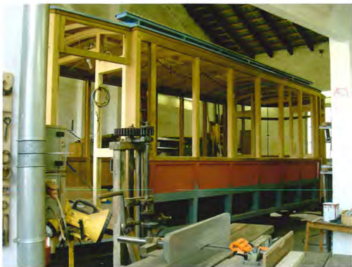
Inde på værkstedet er opbygningen af en helt ny vognkasse i gammel stil i gang - alle dele fremstilles af håndværkerne selv.
