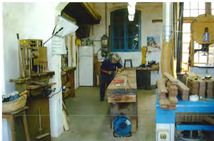
En af håndværkerne høvler et stykke træ til nybygningen på værkstedet.
