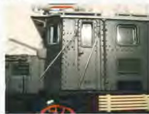
Det er ikke så let at montere overdelen igen og få anbragt håndbøjlerne korrekt i deres huller.
