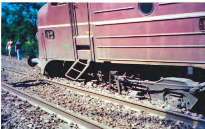
My 1120 fik gravet sig godt ned i ballasten ved afsporingen. Foto Vagn Holstein.
