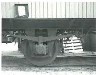
Fe-akselleje på specialvogn i 1963. Foto Vagn Holstein.
