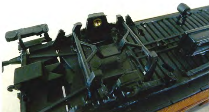
Pinollejer af messing og en hel del 'flash' på trin. Foto Vagn Holstein.
