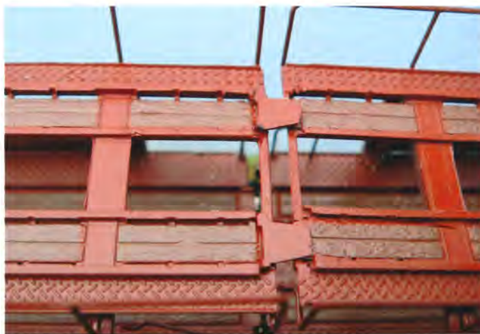
▲ Et blik på vognens øverste dæk med riffelplade, overgangs-plader og fint, spinkelt rækværk af metal.
