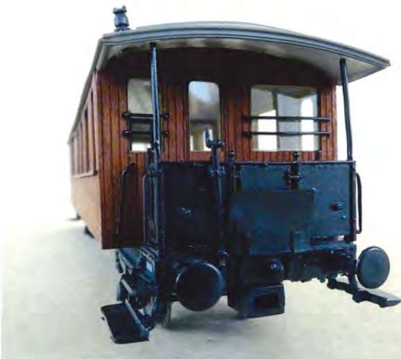
Gavlen på FC-vognen – her ser man desværre også tydeligt 'flash' og de ret grove holdere til taget. Foto Vagn Holstein.
