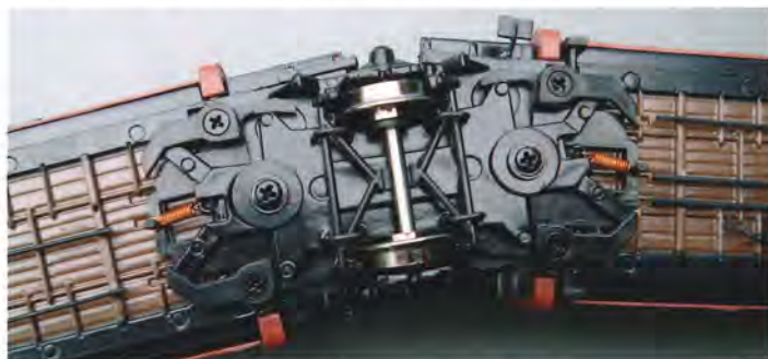
▲ Vognen er leddelt med en meget sindrig konstruktion, der garanterer gode køreegenskaber.
