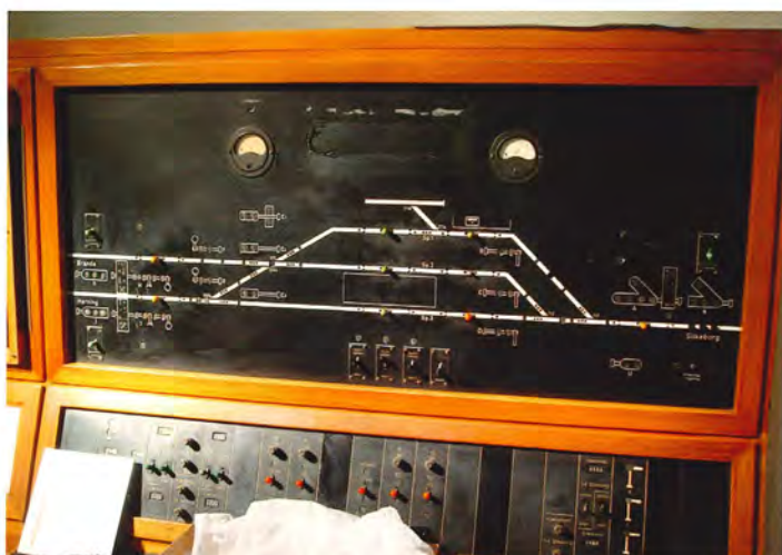
Sportavlen fra sikringsanlægget i Funder.
