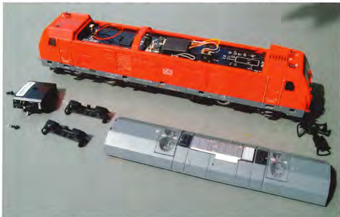
Lokomotivet skal adskilles på en speciel måde.
