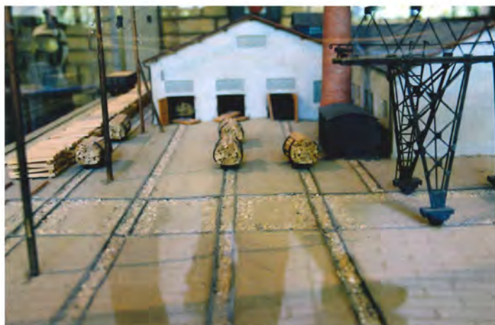
Her ses lidt af den store portalkran, samt små kæpvogne på de tre smalsporsstrækninger, som ender i autoklaverne.
