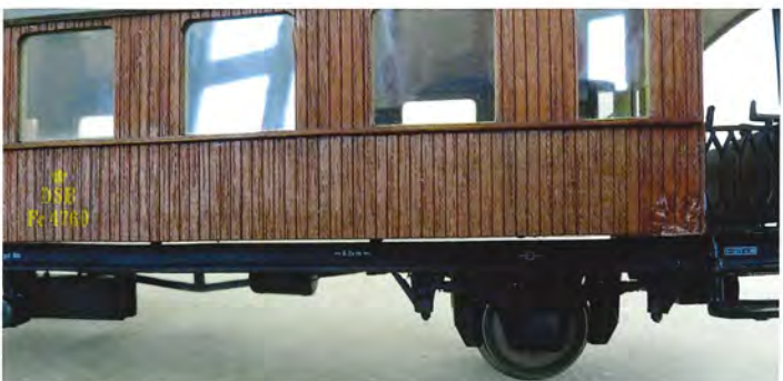
Der er en uheldig spalte mellem vange og vognkasse – som om der mangler et gulv i vognen. Foto Vagn Holstein.
