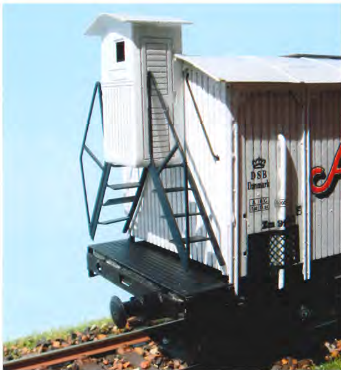
Gavlen med bremsetårnet var skæv – bemærk også spalten mellem bund og vognkasse.
