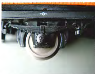
Fjeder og akselleje på FC-vognen – lidt overdimensioneret. Foto Spor og baner.
