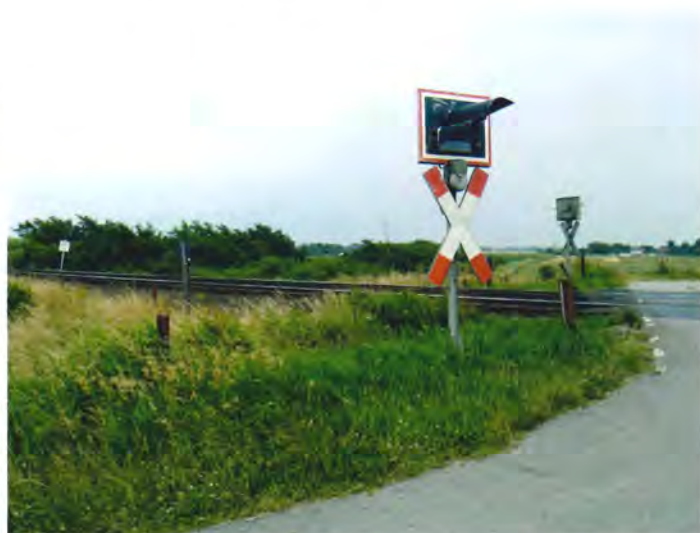
Advarselssignal af speciel type med lysskilt og ikke-fungerende klokke i Dreieckskoog.
