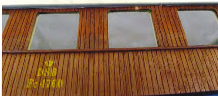
Litrering er lidt for stor. Under taget buler vognsiden noget indad. Foto Vagn Holstein.
