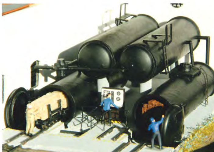
Her er fabrikkens tag fjernet, så man bedre kan se arbejdsgangen. Der køres rå sveller ind i den venstre autoklave, mens den højre åbnes. Herefter vil man gøre klar til at lukke den venstre luge, mens de imprægnerede sveller så skal trækkes ud fra den højre autoklave. Bemærk endvidere styrepulten. Uden for billedet er der en smalsporet skydebro for sporene ind til autoklaverne.
