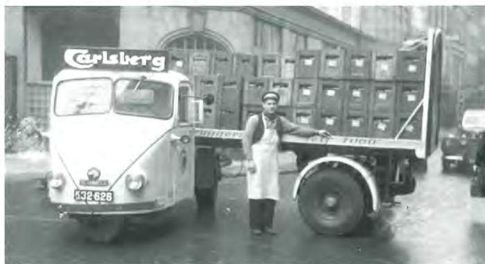
Hestevognens afløser – en Scammell-sættevogn, som Carlsberg havde flere af. Forhjulet kunne dreje 360 grader om sin egen akse. Arkiv Tommy Jørgensen
