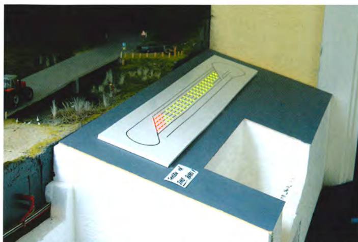
Pulten, der viser, hvilke spor i den skjulte rist, der er ledige eller besat.
