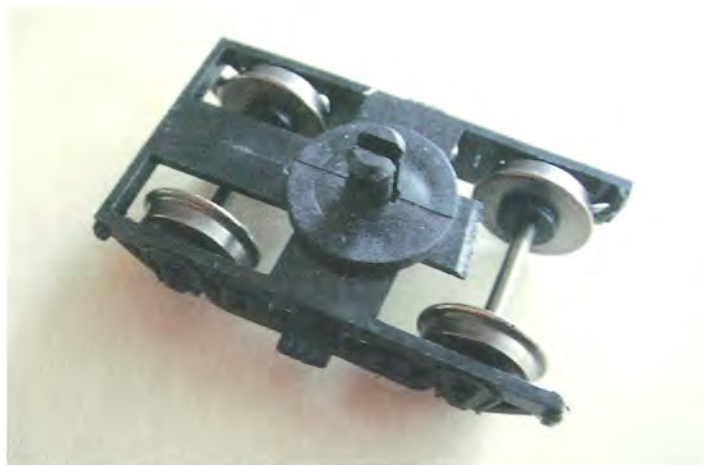
Bogierne skal justeres i den ene ende for at gå fri af Symoba-koblingen.
