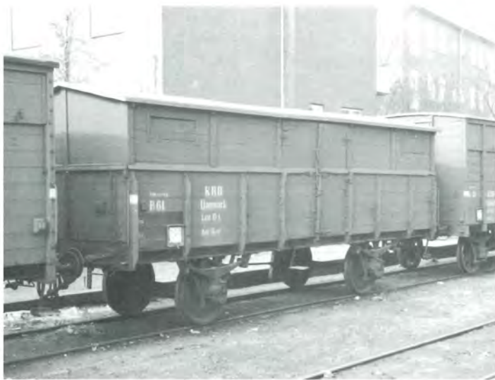
Når man manglede lukkede vogne hos KRB, "overbyggede" man de åbne vogne. Her ses P 61, hvis underdel var en PF-lignende åben godsvogn, der blev ændret allerede i 1918, to år efter den var blevet bygget af Scandia.
