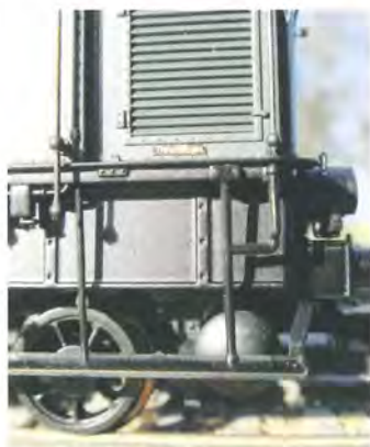
Forenden med Bissel-forløberen og spinkle trinbrætter.
