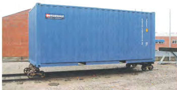
Ny containervogn. Bemærk egerhjul til formindskning af vægten. Foto Tak-Jam.
