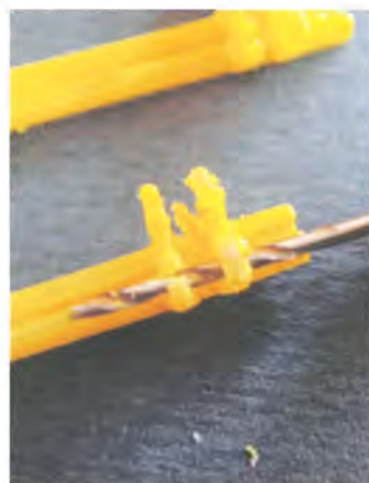
Boring af huller.
