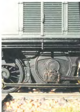
Blindaksel, kobbelstang og egerhjul af meget høj kvalitet.
