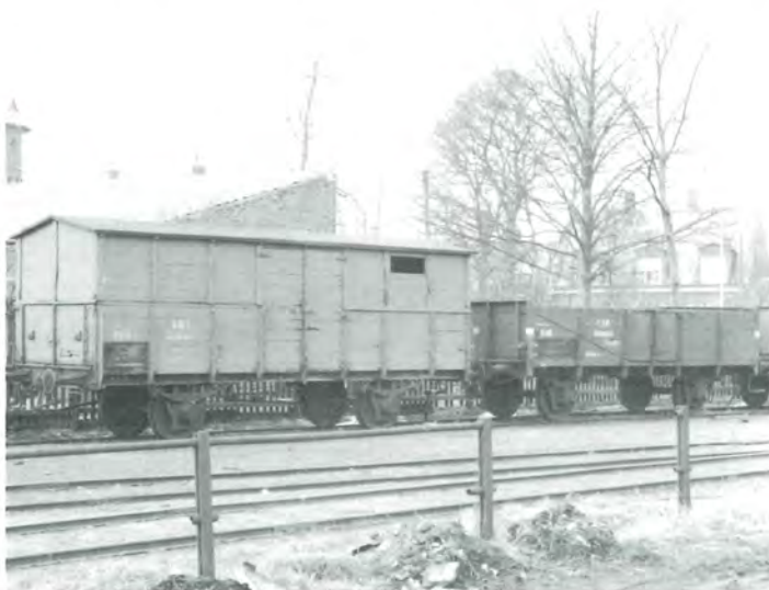
Denne "overbyggede" vogn var af PJ-typen og hed P 64. Den var bygget af Scandia i 1919 og ændret til lukket vogn i 1921. Bag den stod PJ 96, der var af den kraftige tyske type, som ved DSB hed PE. Den var bygget i 1920.
