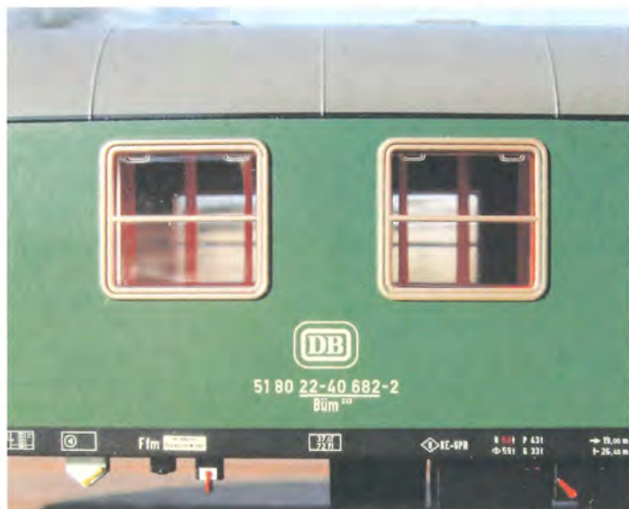
Nr 682 – bemærk håndtagene i vinduerne.
