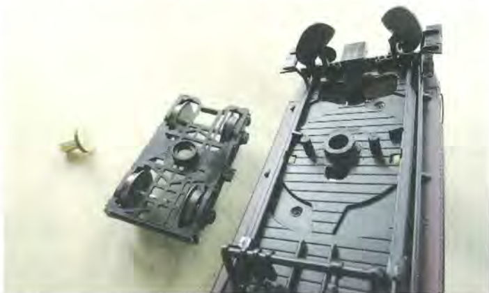
Undervognen skal bearbejdes noget, for at de nye bogier passer.
