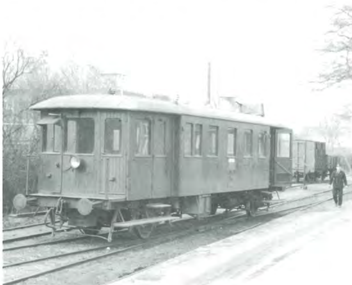
ØSJS M 1 begyndte at rangere under megen knirken og knagen på grund af den lange akselafstand.
