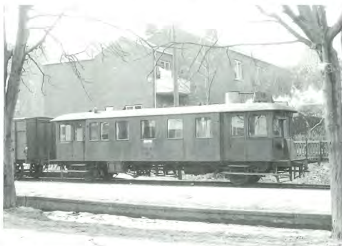
Da vi kom tilbage fra Hårlev, var man ved at gøre den lånte M 1 fra ØSJS klar til at afløse skinnebussen. Bemærk den lange akselafstand.
