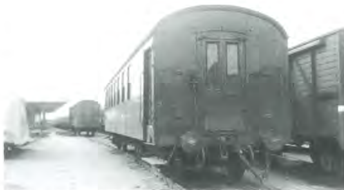
Gavlen på CPE 2987 med håndbøjler og andet udstyr. Odense 1968. Foto Kirkeby, arkiv www.jernbanen.dk .
