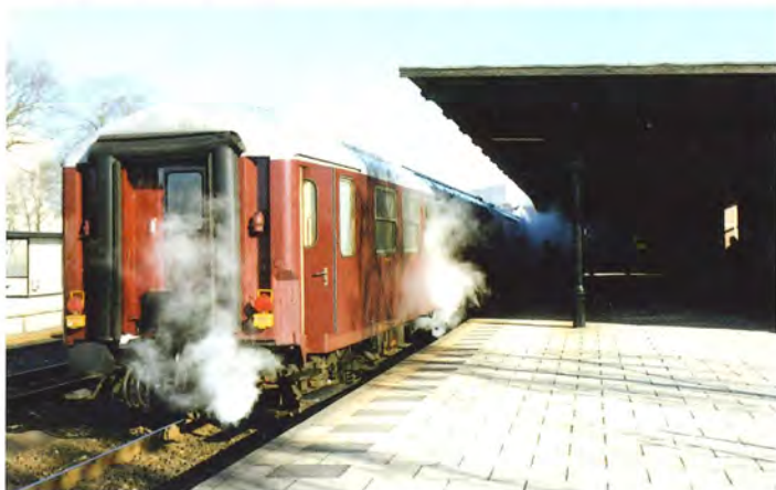
BL 1324 med enkelt-skydedør i gavlen. Aalborg 1997. Foto Flemming Søeborg.
