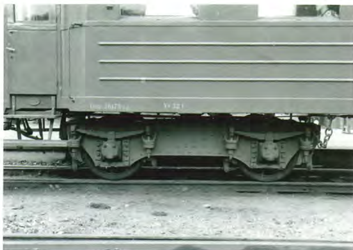
Nærbillede af den specielle bogie under CL 30. Den ser meget solid ud, men er også bygget på Nakskov Skibsværft i 1924 til brug under to motorvogne, der ikke rigtigt duede.
