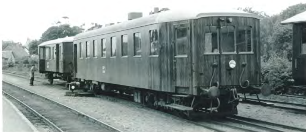
Kielervogn i fuld længde. M 20 havde samme længde som tilsvarende vogne på Fyn og i Randers. Den var i meget fin stand, og endegavlen så helt ny ud. Måske den var repareret efter en kollision. I den modsatte ende var en skydedør ind til et mindre pakrum, hvor jeg senere opdagede, at man transporterede aviser. Motorvognen var bygget af Scandia i 1925 til Kjellerupbanen (SKRJ), hvor den hed M 1, og i 1930 kom den til Løkkenbanen (HLA), hvor den hed M 3 for så i 1945 at ende med at hedde HP M 20.
