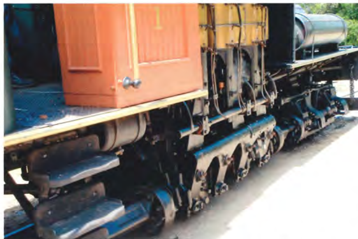
Via snekker og tandkranse overføres trækket til hjulene.
