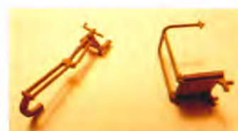
Bremseplatform og spindel til PT-godsvognen.
