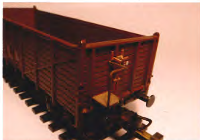
PT-godsvogn med platform og spindel – en fin detalje. Basismodellen er fra Roco.
