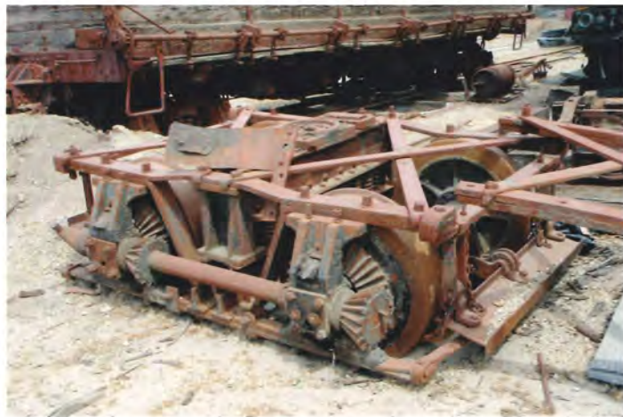
Den specielle Shay-bogie med tandkranshjul og snække. Det er Shay-lokomotivets gearing.
