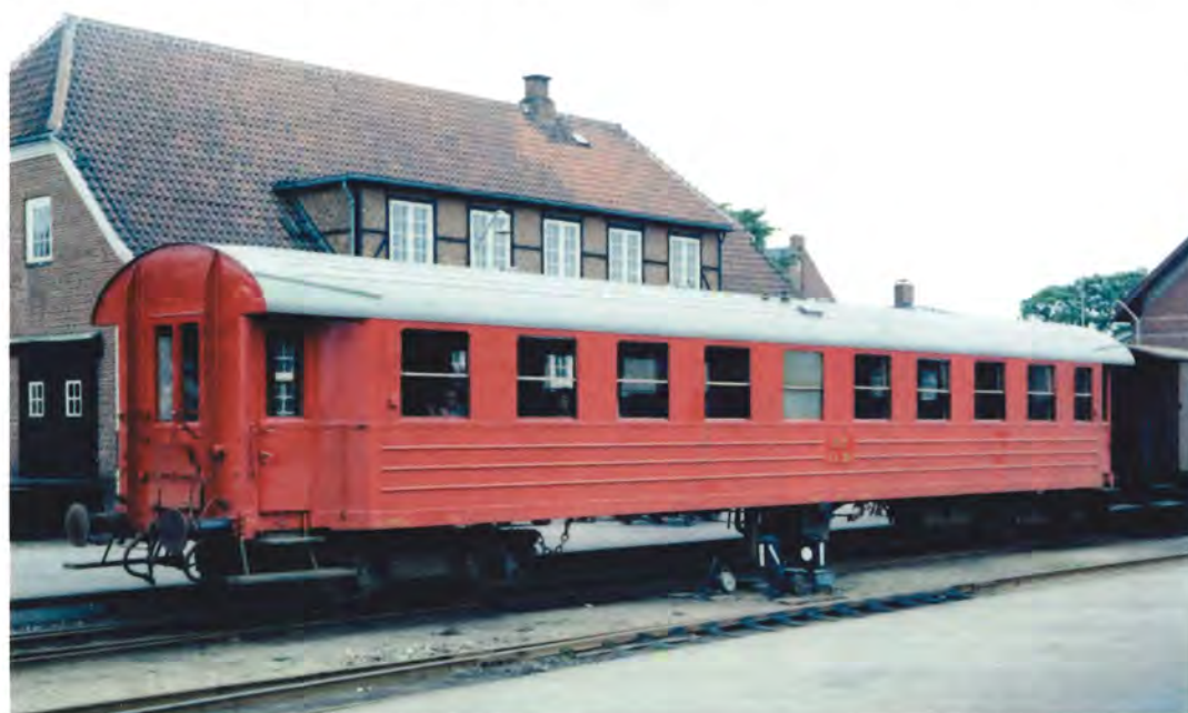
Bogievognen HP CL 30 fra 1948. Bemærk forstærkningerne på siden, som flere af Scandias stålvogne til privatbanerne havde på det tidspunkt. Det er usædvanligt, at toilettet er midt i vognen.
