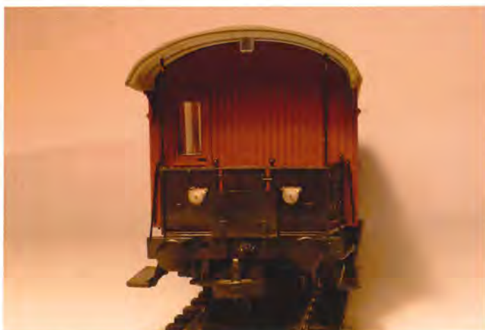
Lysdåserne monteret på CU-vogn. Der mangler 'ledninger', som kan laves af 0,4 mm kobbertråd.
