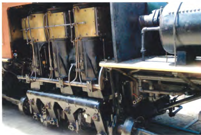
De tre cylindre på siden af lokomotivet trækker på en fælles aksel.
