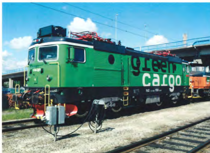
Green Cargo (ex-SJ Gods) Rd2 1093 i Hallsberg 2011. Det er et Rc2-lokomotiv, der har fået mere moderne, elektrisk udrustning, aircondition for personalet osv.
