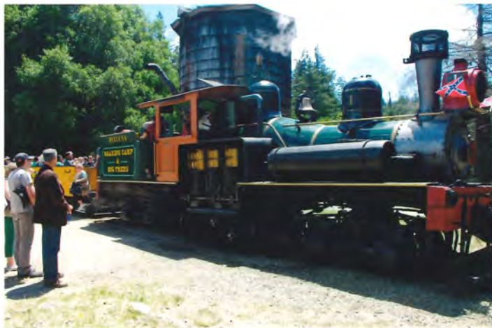
Dixiana 1 er et klasse B Shay-lokomotiv med tre cylindere og to bogier. Foto Sune O. Rasmussen.
