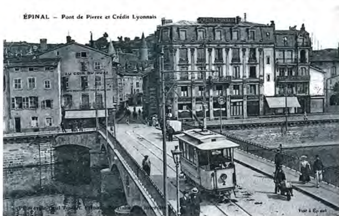
Motorvogn nr. 2 kører på broen over Mosel-floden. Til højre for vognstyreren er der ingen låge, så af- og påstigning er udelukkende sket i bagenden. Hos konduktøren formodentlig?
