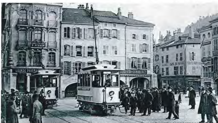
Vognene nr. 6 og 7 mødes ved et vigespor. Bemærk, at stangen på nr. 7 danner en ret stor vinkel med vognens længdeakse. Rulle må derfor have været anbragt drejelig, sådan som den også var det i København fra begyndelsen i 1899 til 1910.
