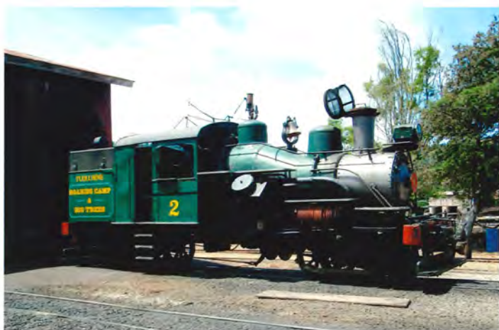
"Tuolumne Hesler 2". Cylindrene stikker ud under kedlen i en vinkel på 45°. Trækket overføres til en kardanaxsel under lokomotivet, der via et differentiale overfører trækket til bogierne. Bemærk brandslangen.
