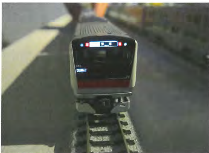
Lys i destinationsskiltene samt i front- og slutlanterner.
