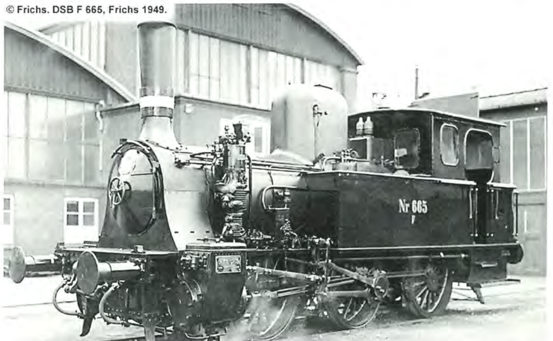
En nybygget F 665 hos Frichs i 1949 efter de gamle tegninger – kraftigere puffer, stor dome og større beholder til kul er de mest iøjnefaldende 'nyskabelser'. Arkiv www.jernbanen.dk .
