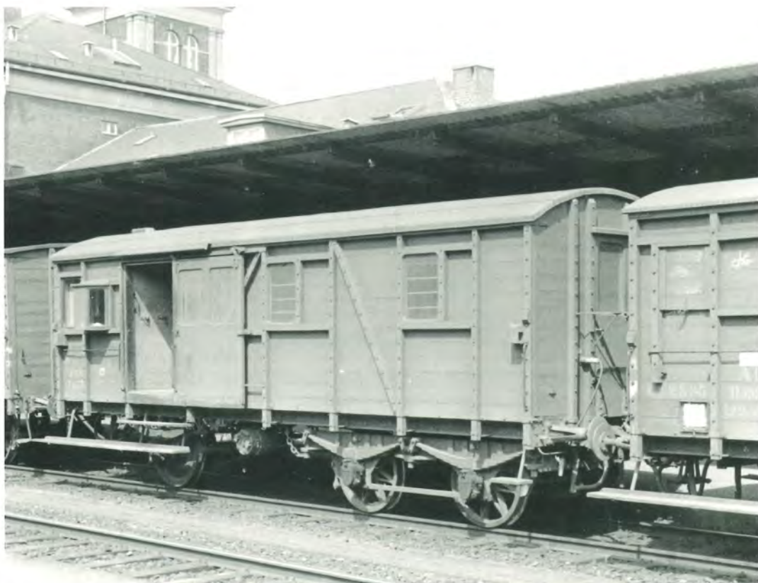
Rejsegodsvognen i ML 1206's tog var AHB Eb 57 af den pudsige model med bogie i den ene ende og fast aksel i den anden. Vognen har stadig udsigtskuplen, så togføreren kunne se langs toget.
