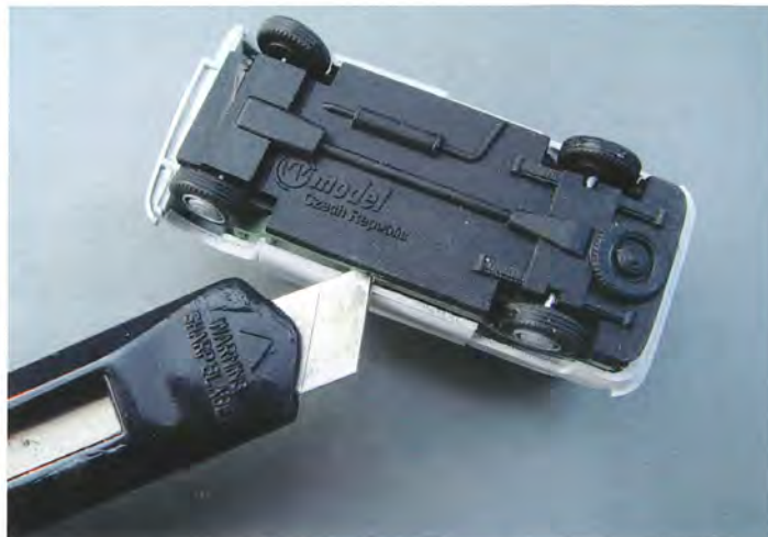
Pres forsigtigt kniven ind under vognbunden og løsn den fra overdelen.
