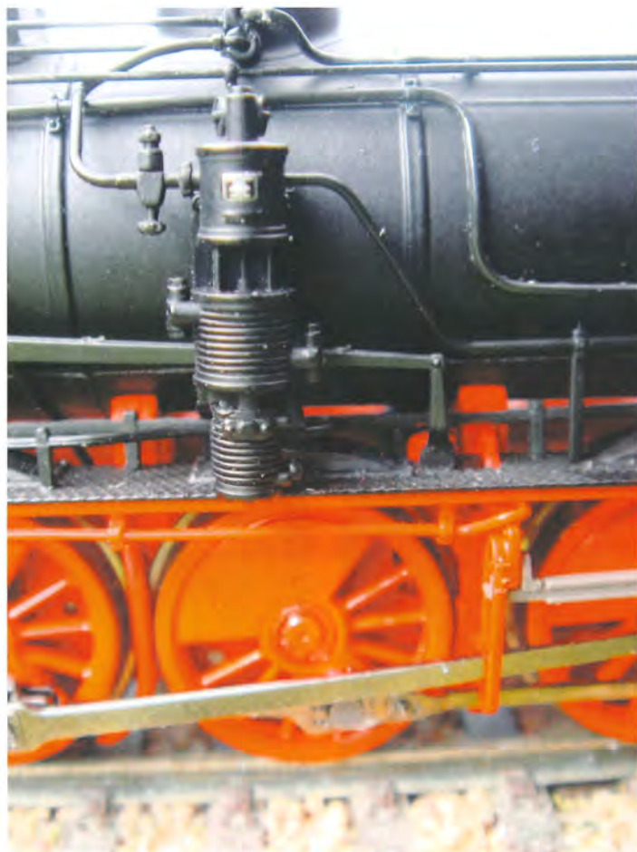
Trukluftpumpe og andre detaljer. Bemærk fabrikkens skiltet øverst.
