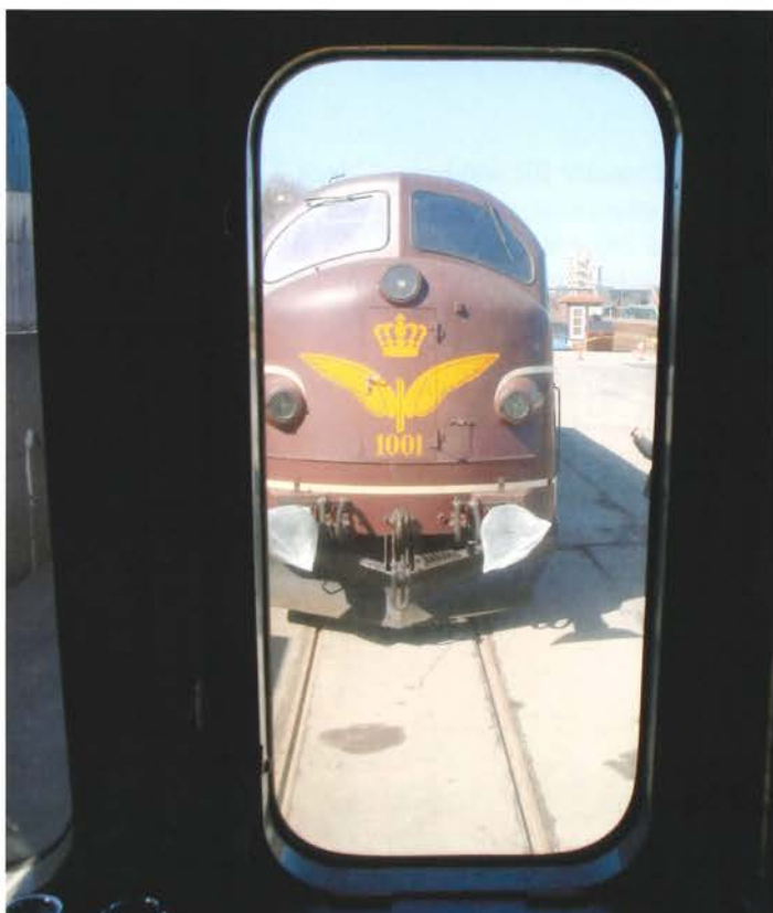
Mx 1001 set fra Mo 1846. Plastic'et på pufferne skærmer mod grafitfedtet.
