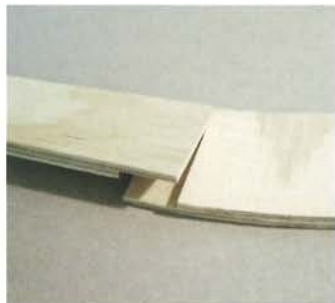
Nedfræsninger giver glatte overgangen mellem de enkelte elementer i spindlen.
