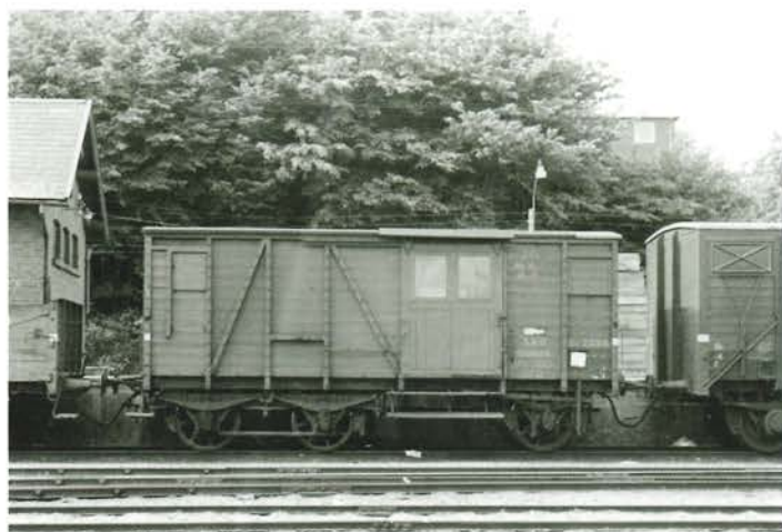
I godstoget til Aalborg var der en del ejendommelige vogne. Her er en tidligere rejsegodsvogn blevet til en godsvogn AHB QE 2335. Den har bibeholdt bogien i den ene ende, hvor der var beregnet til mest rejsegods.
