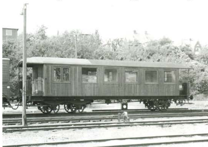
Togførervognen FFJ Cb 1 var fantastisk velholdt og havde et mærkeligt dobbeltvindue, hvor varmekedlen havde været. Bygget af Scandia 1913 og stadig med lakeret teakbeklædning og rammevinduer.
