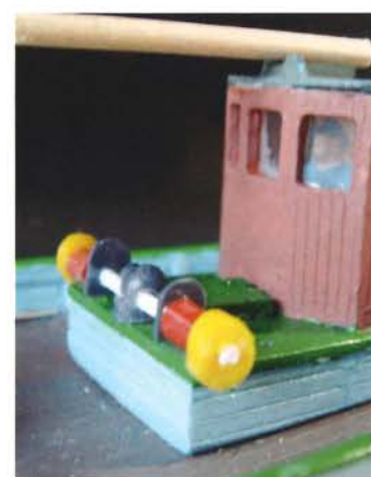
Ophalersspillet består af diverse plaststumper og rør.
