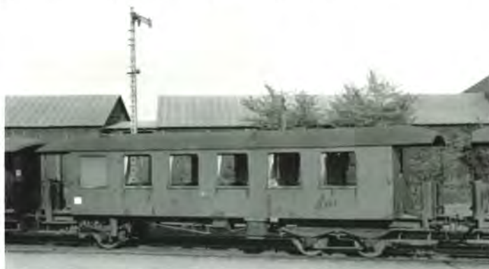
FFJ CB 3 var også speciel, idet den havde en lille simpel bogie i den ene ende, hvor der havde været en stor kedel til togopvarmning. Den var bygget af Scandia i 1924, men var blevet moderniseret i 1952. Den havde dog beholdt sine spejlglasruder, hvoraf i hvert fald nogle kunne åbnes.
