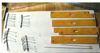
Fremstilling af de forskellige dele til færgen, herunder dæksplanker. Foto Bjarne Abel.
