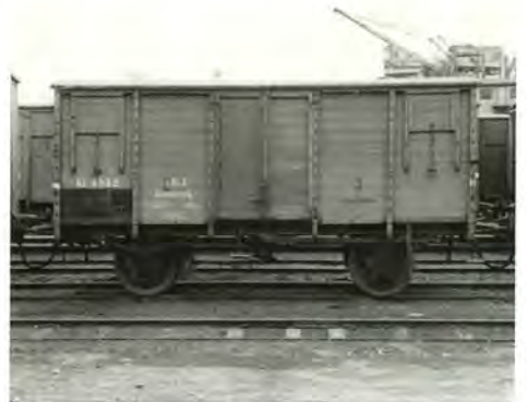
AHJ (Hadsundbanen) KL 4542 skilte sig ud fra de mange Q-vogne på flere områder. Dels var den lavere, og dels var den udstyret med pladehjul, der gav den spinkle vogn et specielt udseende.
