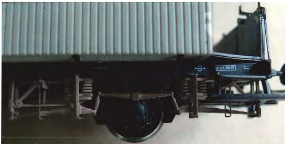
P. Hansen fjederen monteret på en Hobbytrade vogn, holdt på plads uden lim!
