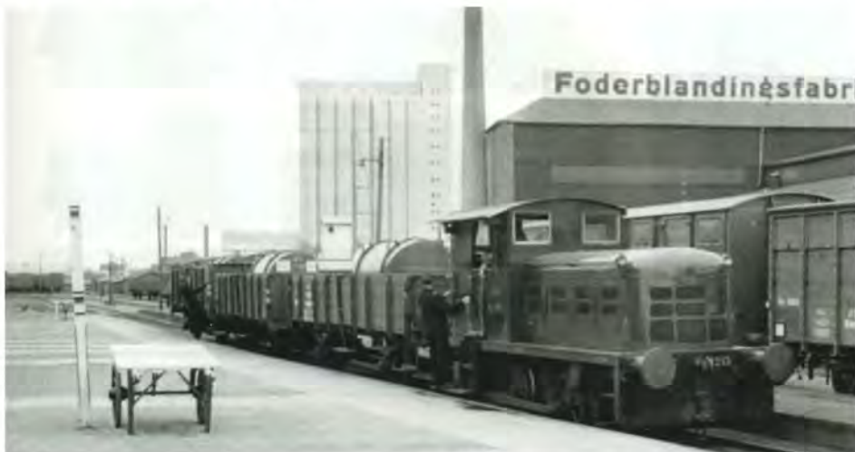
Fowlertraktor FFJ M 1215 rangerer med tre åbne DSB-godsvogne på Nørresundby Havn. Første vogn efter traktoren er en PF, og derefter følger en PJ og sidst en PB. Læg mærke til det ekstra lille tag over førerpladsen, der kun findes i højre side.
