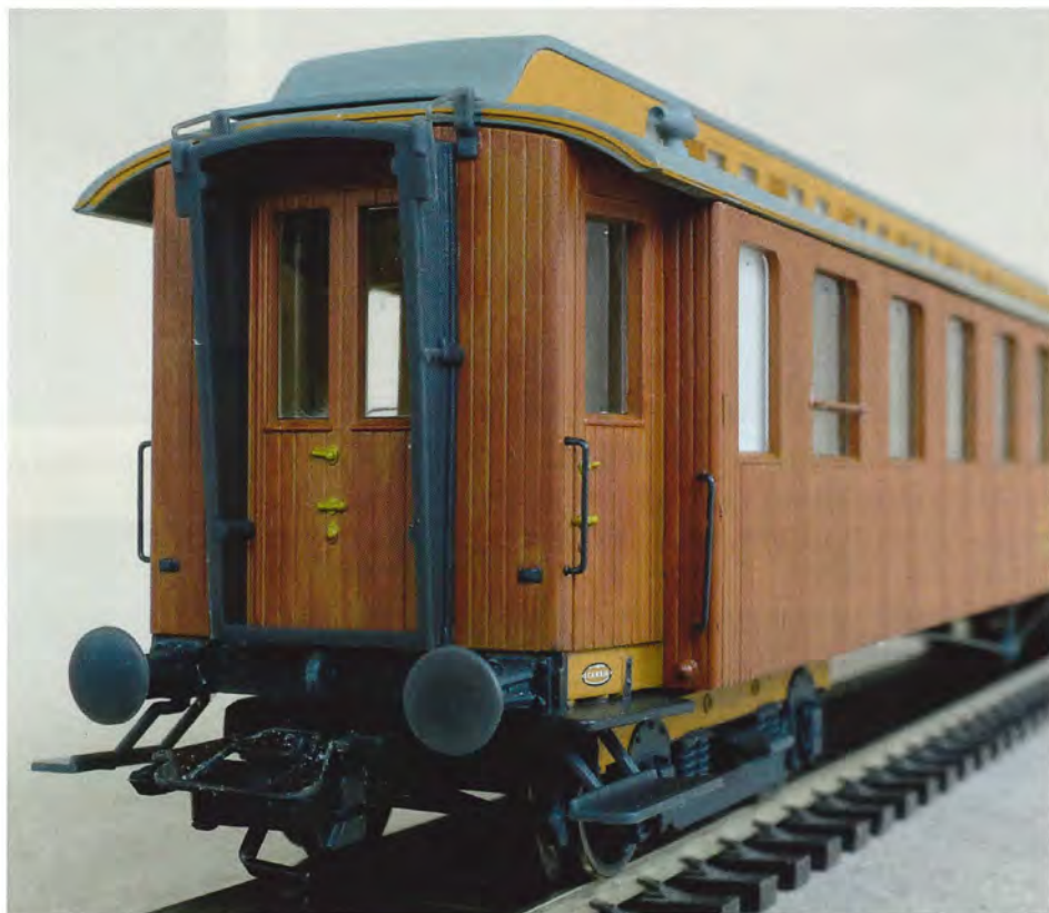
En smuk gavl, men ærgerligt at overgangspladen mangler. Læg mærke til den okkerfarvede stribe på tagkanten: det skal illudere den træliste, som var skruet på hele vejen rundt langs tagkanten.
