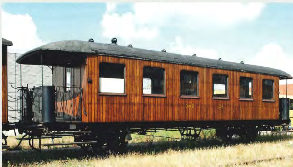
Udover lokomotiver tegnede Milling også togvogne. Her er den en af de nyeste med lodrette teakstave og hvælvet tag. Vognen blev bygget i 1910, og står fortsat stort set uændret på Danmarks Jernbanemuseum. (Foto: Asger Christiansen)
