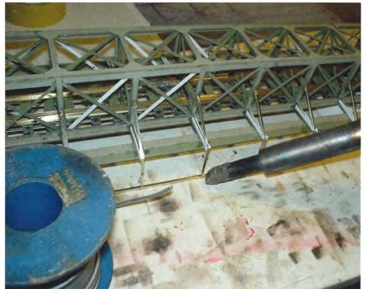
Af spor N-skinneprofiler er fremstillet skrå bærearmer til den udvidede gangbro, ligesom der af samme materiale er fremstillet nyt gelænder i spor 0-højde
