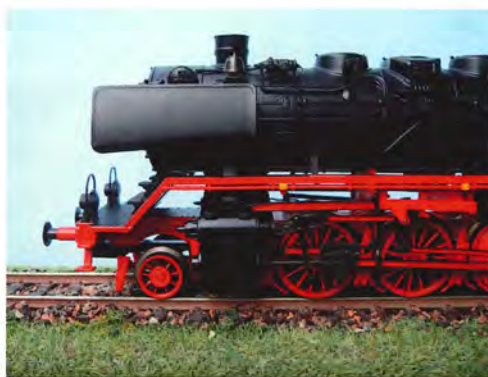
Den markante front med Witte-plader
