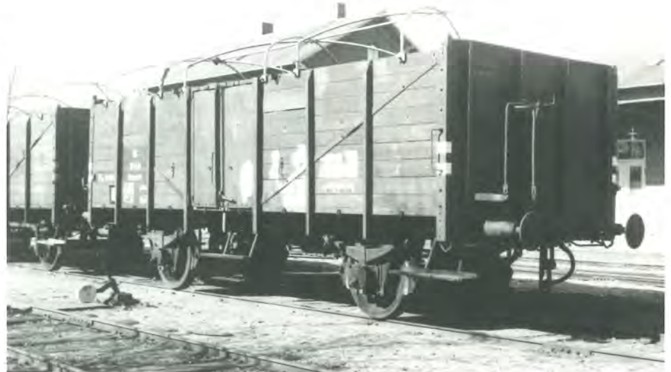
PTR 9596 med presenningstativ og lille bremseplatform. Her kan en del detaljer tydeligt ses, bl.a. bindinge og håndbøjler. Foto: Danmarks Jernbanemuseum.
