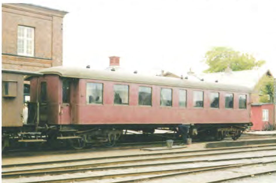
Jeg tog et farvebillede af A 2. Man ser tydeligt de meget korte træbogier. Vognen er udstyret med toilet i midten af vognen, hvilket ikke er så almindeligt for så lang en vogn.
