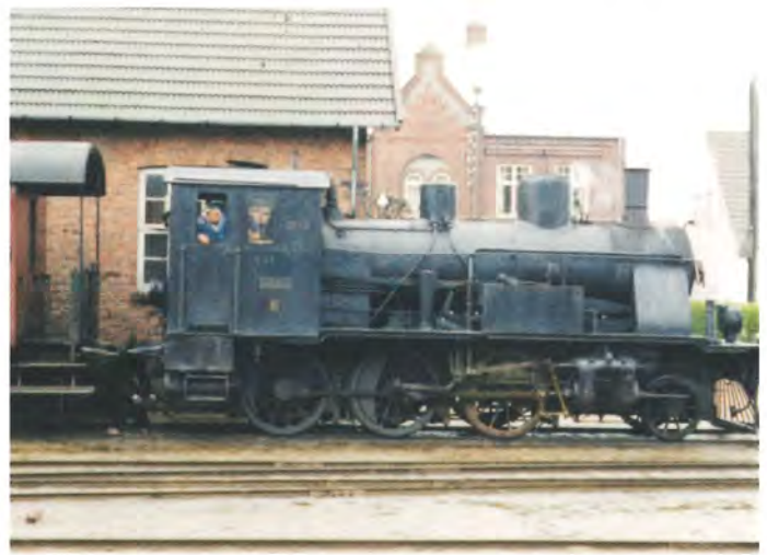
Portøren er kravlet ned mellem togførervognen og lokomotivet for at skille tryklufsledningerne ad. Bemærk hvor lavt lokomotivet er i forhold til personvognen. Pladerne på siden af førerhuset har ikke rød baggrund som på nr. 3, men ellers er lokomotivet nydeligt holdt.
