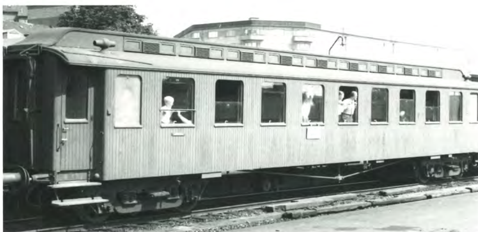
Teak CM mellem MY og spids CM i Randers engang i 1950'erne. I første kupévindue ses den tværstang, som skulle beskytte spejlglasruden, hvis man skulle løfte en bære ind. Alle CM var udstyret med den, også i gangsidene. Det lille skilt under vinduet viser at kupéen var "Fortrinsvis for rejsende med hunde", det sad normalt i sidegangen. (Foto: Hans True)
