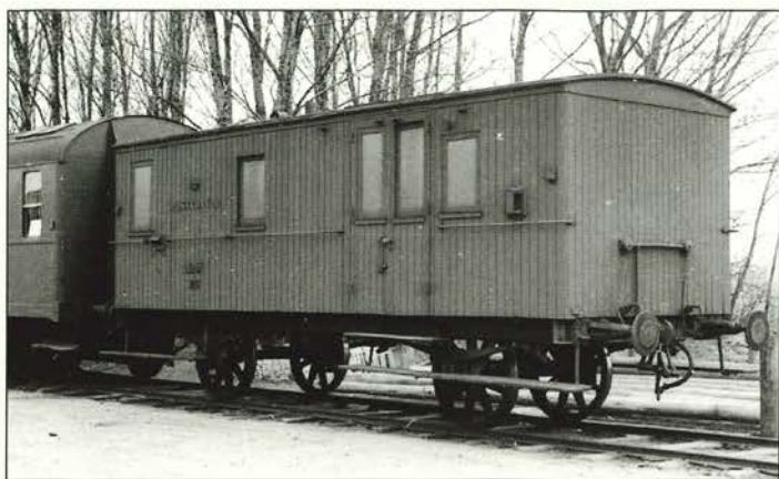
På et sidespor med meget spinkle skinner stod en fin lille LJ-postvogn nr. 76. Alle påskrifter inklusive en krone var af messing og skruet på teaktræsbeklædningen. Tilsyneladende har den ingen bremses. Foran den stod DSB's største postvogn litra DC.
