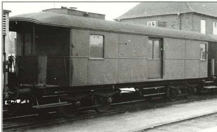
M 62 var en dampgeneratorvogn af nyeste model. Den var ombygget fra en toakslet personvogn, men det var nu svært at se. Det har nok kun været rammen, der var blevet genbrugt, men det var ellers en pæn vogn udstyret med cylinderpuffer og rullejer.
